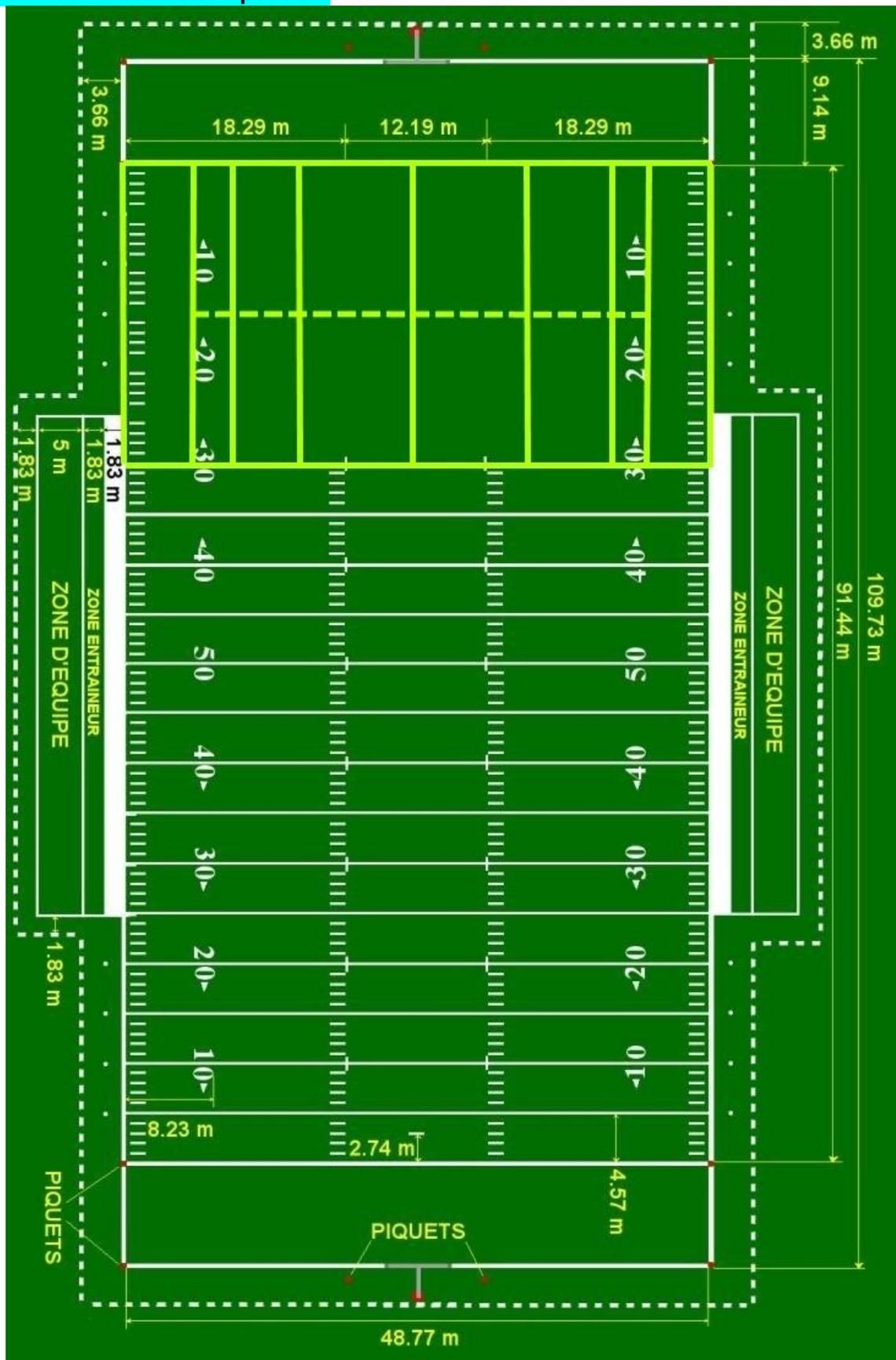
**NOTE D : SCHÉMAS ET DETAILS DU TERRAIN**
